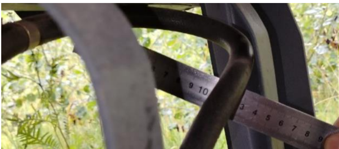
Рисунок Е.2 Диаметр изгиба менее 160 мм (контролировать линейкой)
